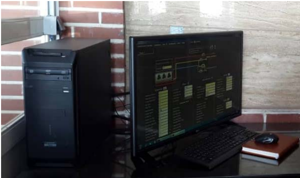
یک سیستم ثبت دمای سردخانه اتوماسیونی متصل به حسگرهای درون محفظه ضدعفونی
